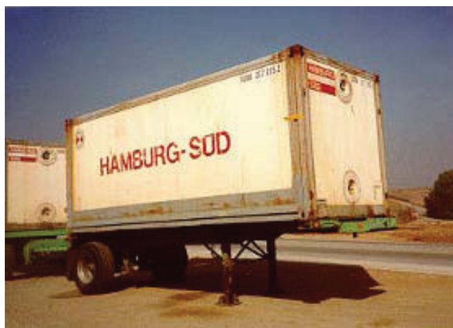
Figura 5.12 Kontejner ftohës i cili shfrytëzon pajisje për ftohje
