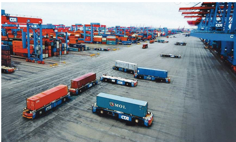
Figura 7.10 Mjete automatike për ujë AGVS
